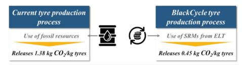
Figura 2. Comparación de la Huella de Carbón entre procesos de producción.
